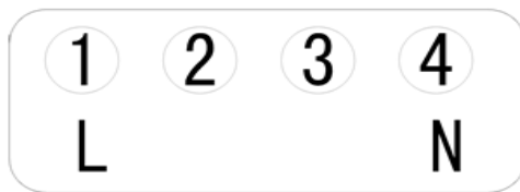
图 7 终端 II 型本体主接线端子示意图
